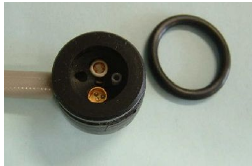
プローブ内面写真 プローブ開口面をソフィスタ KR0672-R(クラレ)で覆った写真
