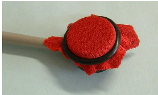
プローブ内面写真 プローブ開口面をソフィスタ KR0672-R(クラレ)で覆った写真
