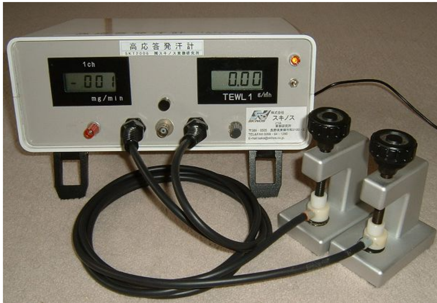
空気流量補償型発汗計試作機 高応答発汗計 スキノス SKT2006
