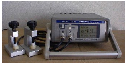
図 10 空気流量補償方式デジタル発汗計 (SKN-2000) の外観写真
